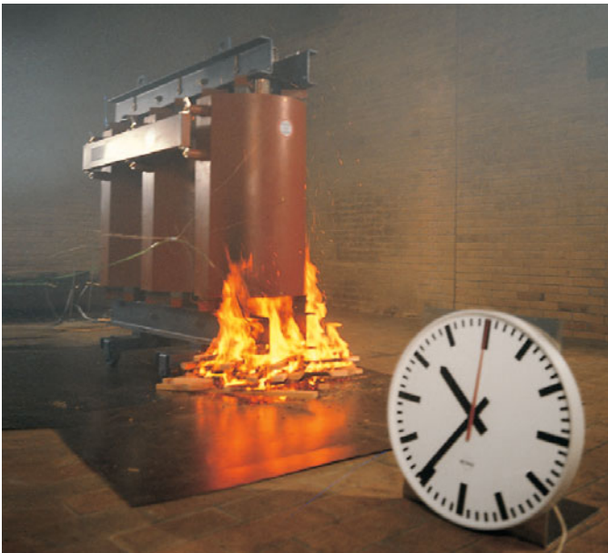
Figura 5.9-6: Prueba de inflamabilidad del transformador de resina colada
