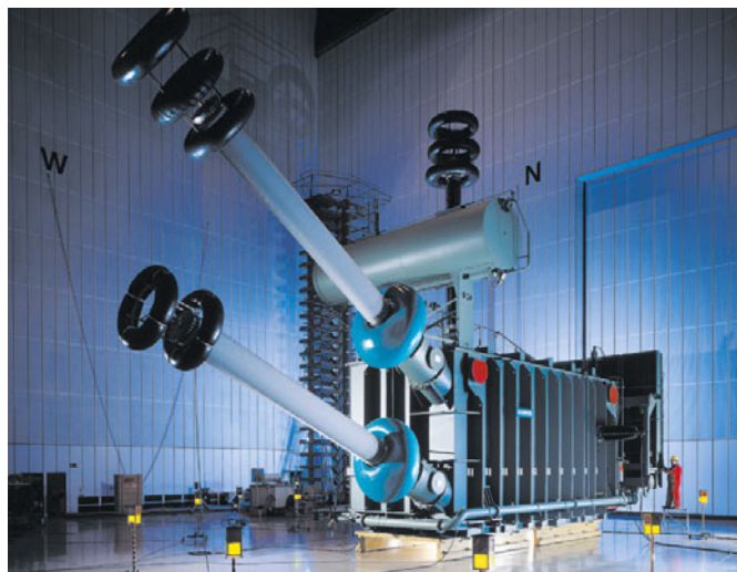
Figura 5.8-2: Transformador convertidor para transmisión bipolar HVDC sistema \pm 500 kV CC; 2.500 MW: monofásico; 420 kV CA; 515 kVCC; 397 MVA; sistema en estrella (lado izquierdo de la figura) y sistema delta (lado derecho de la figura)
